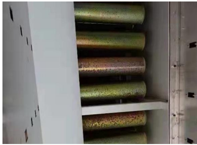
发泡废气活性炭吸附装置内部
