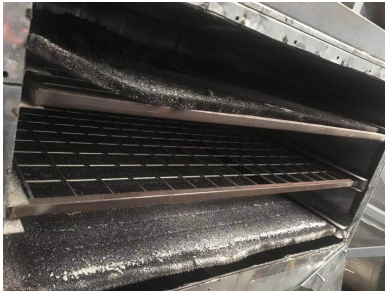
喷胶废气活性炭吸附装置内部
