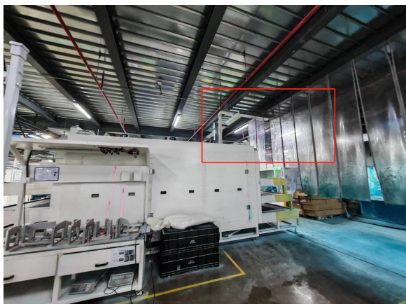
烘道废气收集至总管
