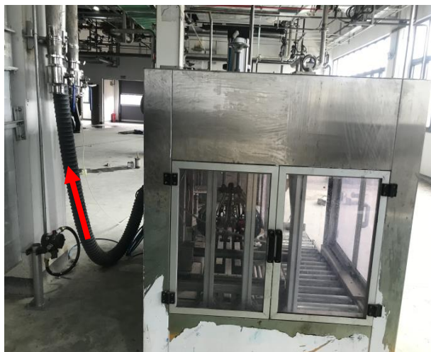
灌装机废气收集装置（全封闭）
