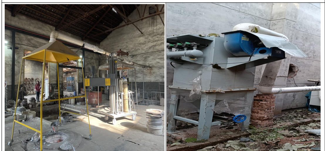
集气罩+旋风+布袋除尘器
