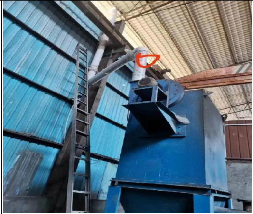
旋风+脉冲布袋除尘器+15m高排气筒
